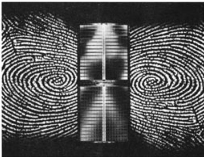
Figura 3: El chip de 16 megabits: Sobre la yema de un dedo caben 700 hojas escritas a máquina (Servicio de prensa de Siemens 1991).
